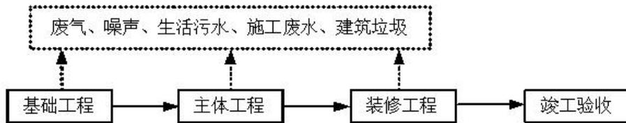
图3 施工期工艺流程及产排污环节图
